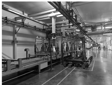
图11 金属化膜电容器元件喷金自动传送线实施效果图
